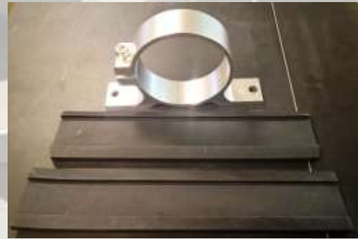
Support simple : Ø 59.2 mm avec 1 caoutchouc Ø 51.6 mm avec 2 caoutchouc Trou ø6 - entraxe 111mm VP00701-66
