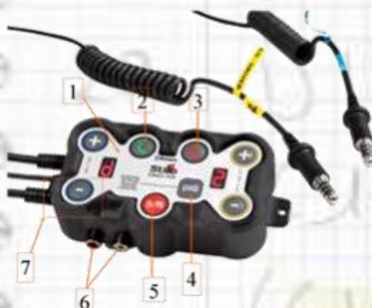
Radio équipée d'un système d'atténuation digitale des bruits extérieurs, avec des fonctionnalités simplifiées.
