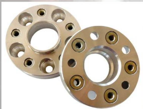
Double centrage avec insert filetés
